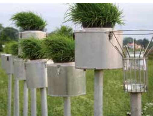
Behälter mit Weidelgras sowie Auffanggefäß für Staubniederschlag, an dem die Einlagerung von Luftschadstoffen nachvollzogen werden kann.
